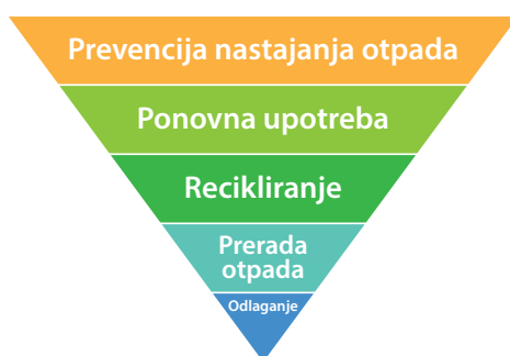
Slika 1: Hijerarhija upravljanja otpadom propisana Okvirnom direktivom EU o otpadu (WFD, Direktiva 2008/98/EC)
